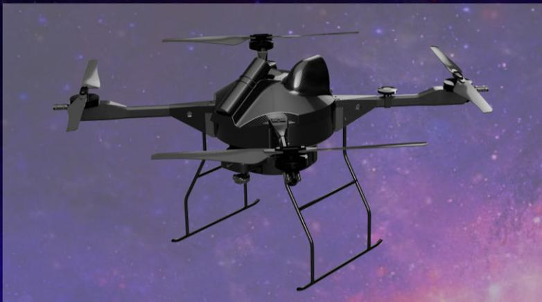
エンジンジェネレーターを搭載したハイブリッド型は、カテゴリーIII飛行を前提としたオペレーションに不可欠な、長時間飛行を実現。
